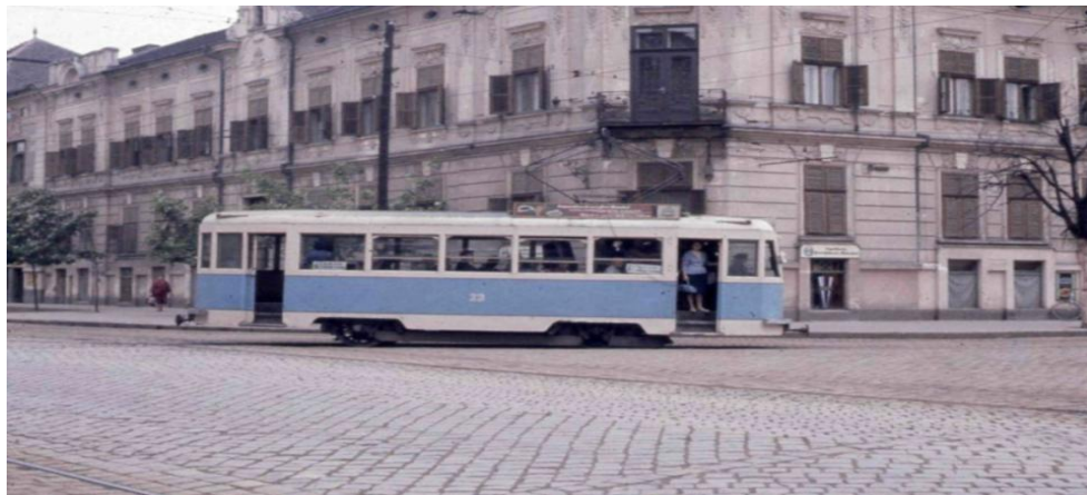
Figura 4.8 - Primul vagon Pionier simplu, reconstruit din VM tip B, în cadrul atelierelor ITT
