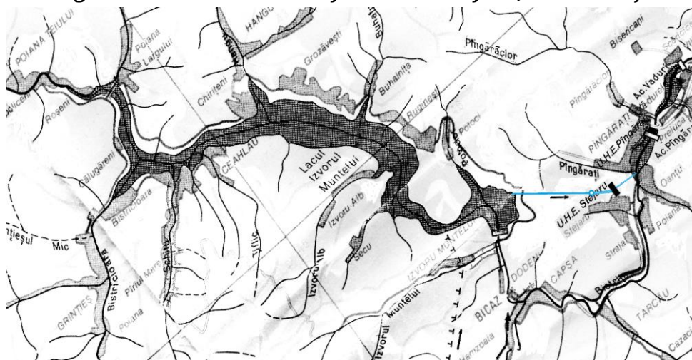
Fig. 34. Schema de amenajare a CHE Stejaru, râul Bistrița
